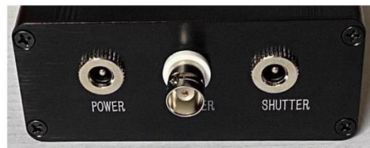
后面板电源 12V，BNC 外触发，快门接口
